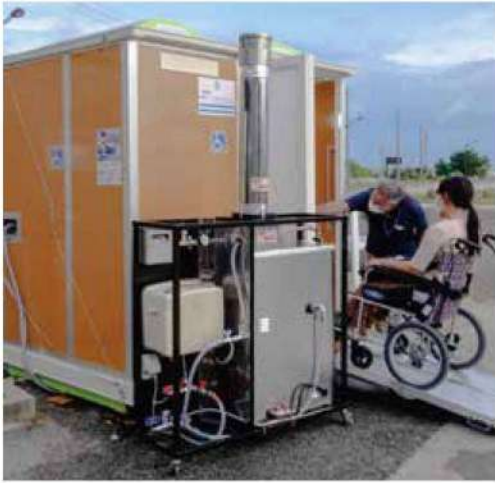
▲旧Ⅲ型のスロープを登る車椅子ユーザー様。 1枚扉は風圧で開けにくいと思い折戸を開発しましたが、戸を開ける際に、車椅子に座ったままだと折戸は手間取るとお声を頂きましたので、改良型では引戸へと変更しました。
